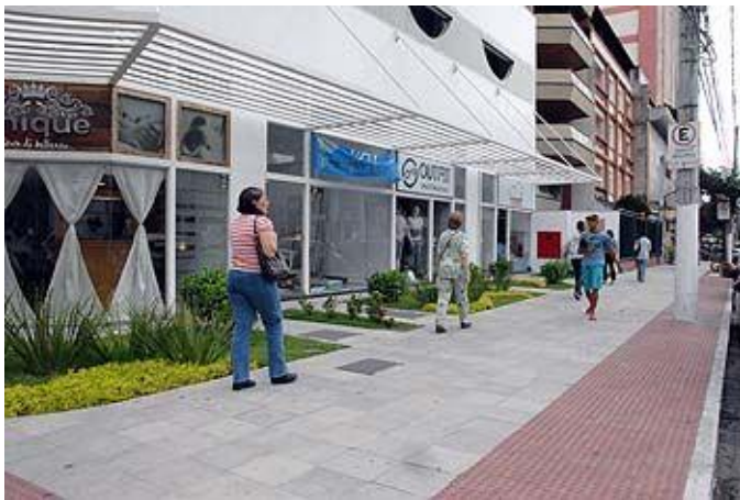
Figura 04 – Calçada composta das três faixas, com destaque para a faixa livre.
